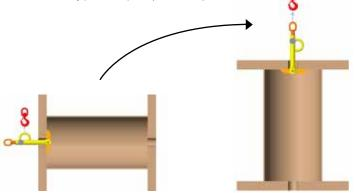
\* TIP UP REEL FROM A ROLLING POSITION TO AN UPRIGHT POSITION, PAY OUT REEL IN UPRIGHT POSITION PART NUMBER 12782 & 13037
